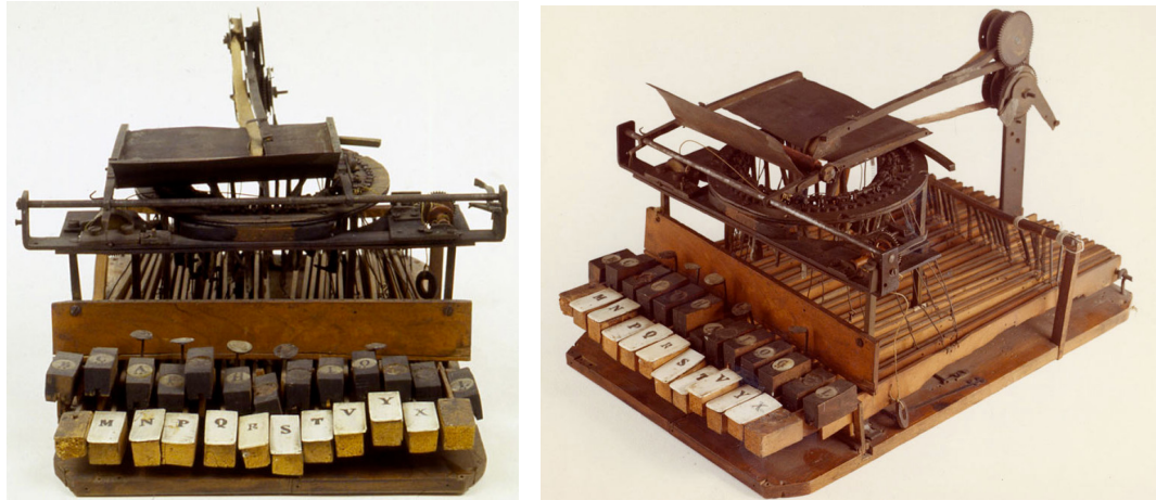
Figure 6.5: The Cembalo Scrivano invented by Giuseppe Ravizza in 1855. Picture retrieved from Museo Nazionale della Scienza e Tecnologia Leonardo da Vinci, on-line archive – last access April 14, 2023.
